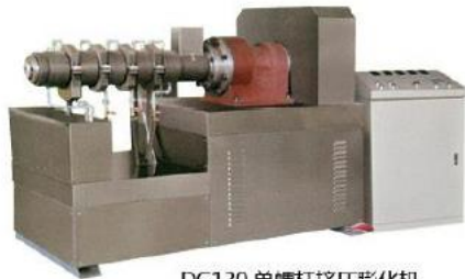
DG130 单螺杆挤压膨化机 Single-screw extruder
