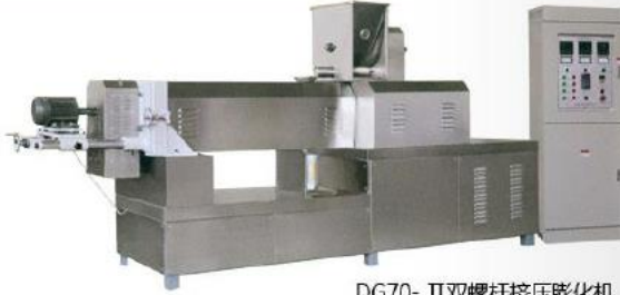
DG70- II双螺杆挤压膨化机 Twin-screw extruder
