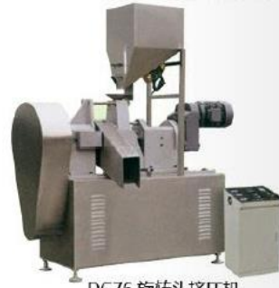
DG76 旋转头挤压机 Rotary head extruder
