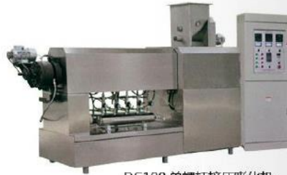
DG100 单螺杆挤压膨化机 Single-screw extruder
